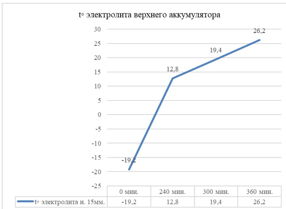
Рис. 4. Время нагрева аккумулятора при работе устройства
